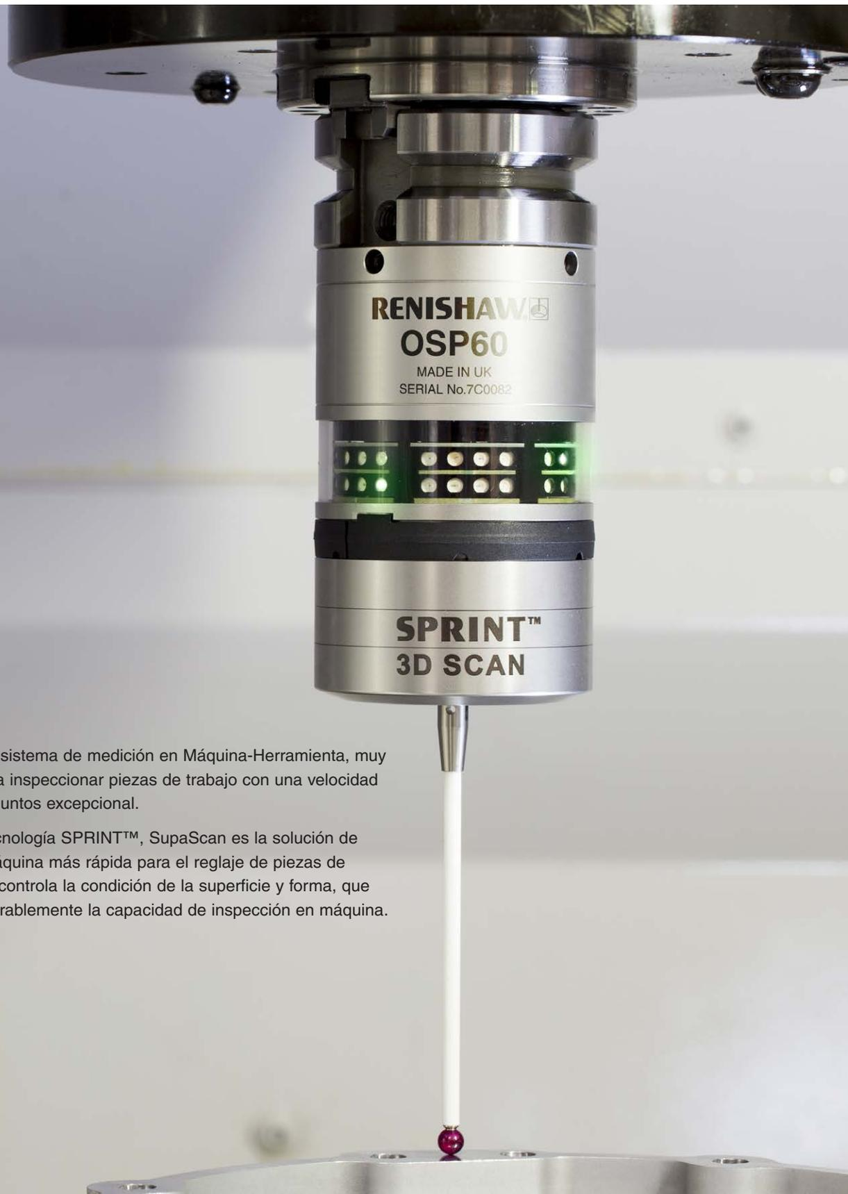
SupaScan es un sistema de medición en Máquina-Herramienta, muy fácil de usar, para inspeccionar piezas de trabajo con una velocidad de medición de puntos excepcional.
