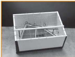
Una vez solidificado, se corta el molde para abrirlo y retirar el modelo, dejando una cavidad de molde con una réplica exacta de modelo.
