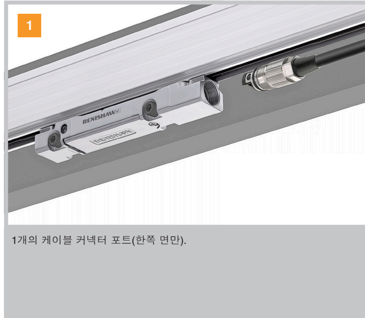
케이블을 판독 헤드에 삽입합니다. 올바른 커넥터 방향에 주의하십시오. 커넥터 키 에지가 판독 헤드 베이스를 향해야 합니다.
