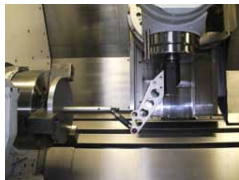
QC20-W球杆仪正在数控车床上进行测试
