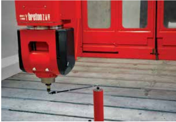
Breton使用雷尼绍QC20-W球杆仪来检测机床定位性能
