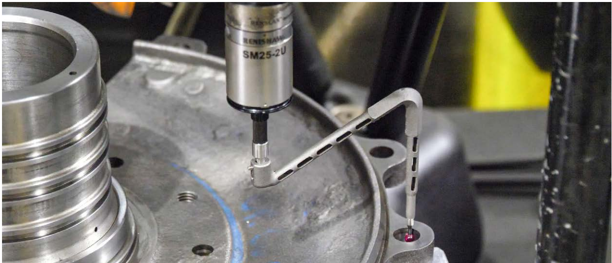
在RenAM 500Q系统上利用金属3D打印技术打造的定制测针
