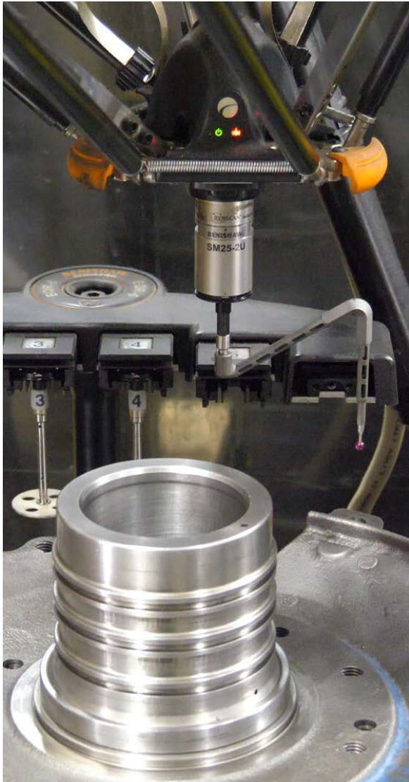
在Equator 300比对仪上使用增材制造测针检测汽车零部件
