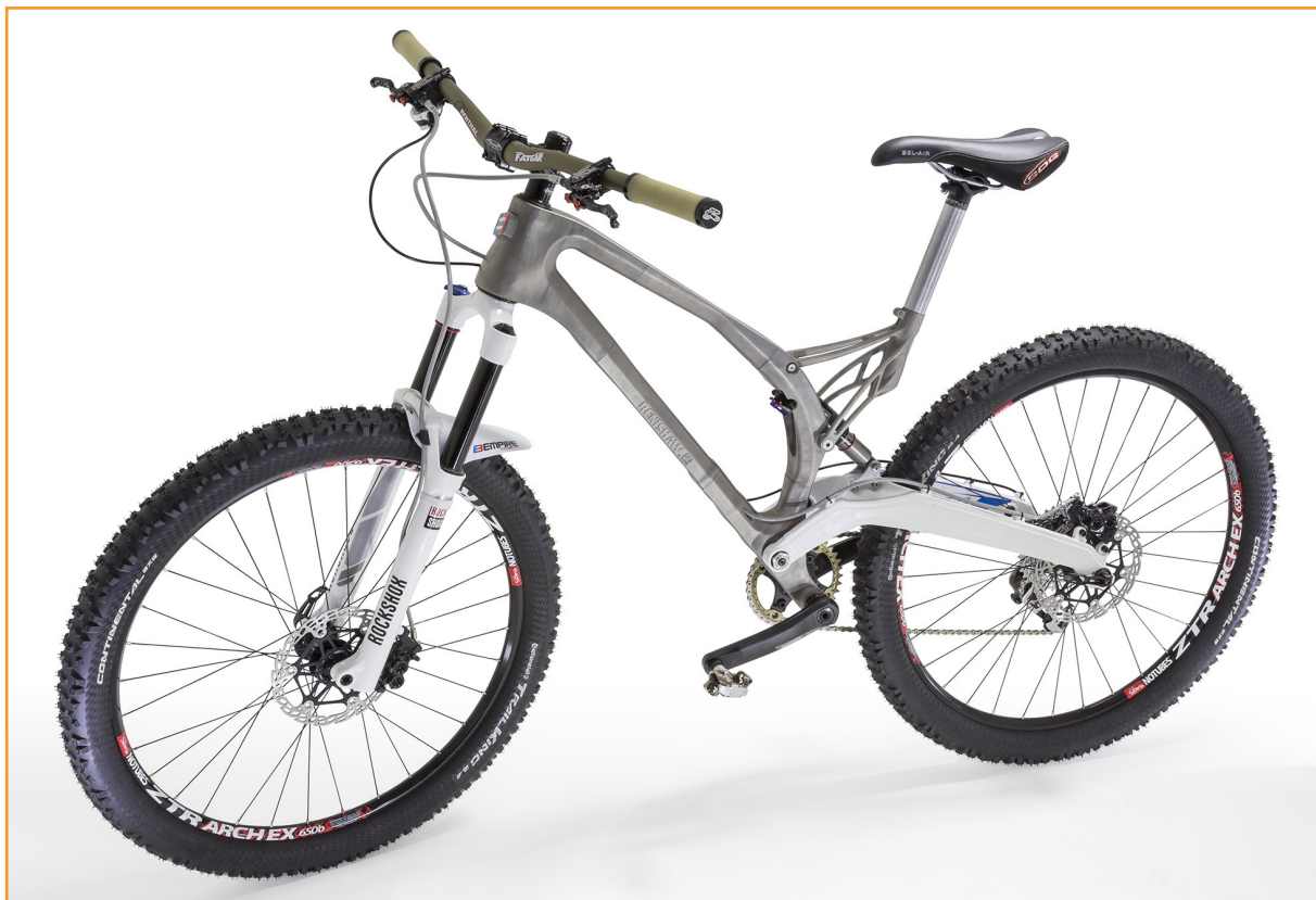
Komplett cykel med 3D-utskrivna ram och sadelfäste i titanlegering
