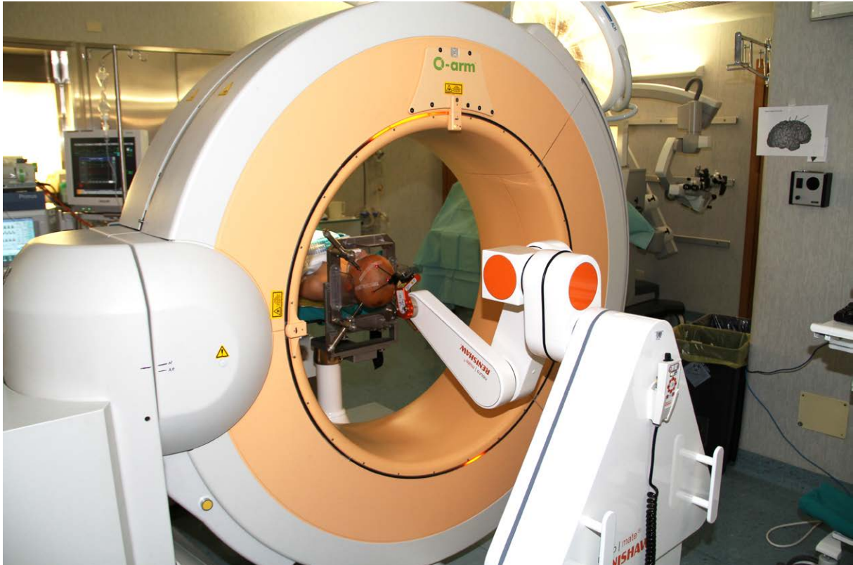
Utilizzo del robot neuromate con un modulo per TC intraoperatoria a pannello piatto
