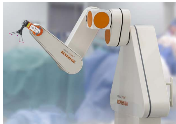
Robot stereotassico neuromate con modulo "frameless" neurolocate di registrazione paziente
