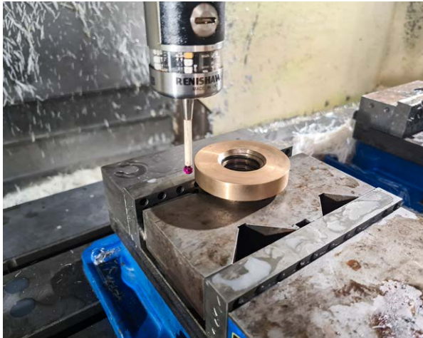
Réglage et contrôle des pièces à l'aide d'un palpeur à transmission optique OMP40-2 de Renishaw
