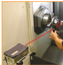
XR20-W Drehwinkelmeßgerät Zur Messung von Drehachsen
