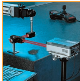
XL-80 Laser Interferometer Lasersystem zur Messung von Werkzeugmaschinen und Koordinatenmessgeräten
