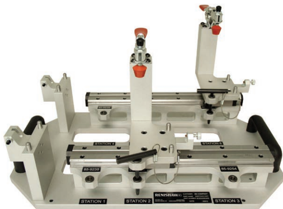
Los rieles lineales permiten sujetar varias piezas con longitudes distintas.
